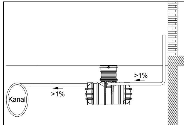
**Wichtig:** Das Leerrohr ist an einer Öffnung **oberhalb** des max. Wasserstandes anzuschließen.
