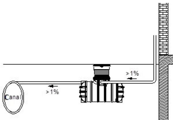
**Important :** La gaine PVC contenant le tuyau d'aspiration et les câbles doit être raccordée **au-dessus** du niveau max. de l'eau.
