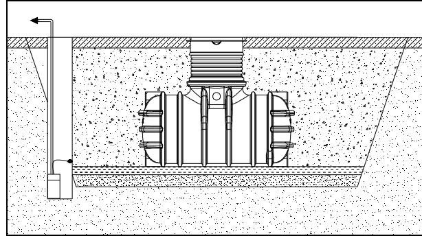
Die Pumpe ist regelmäßig zu überprüfen. Die Größe des Rohres richtet sich nach der Größe der verwendeten Tauchpumpe. Der Schwimmerschalter muss auf jeden Fall seine Funktion erfüllen können.
