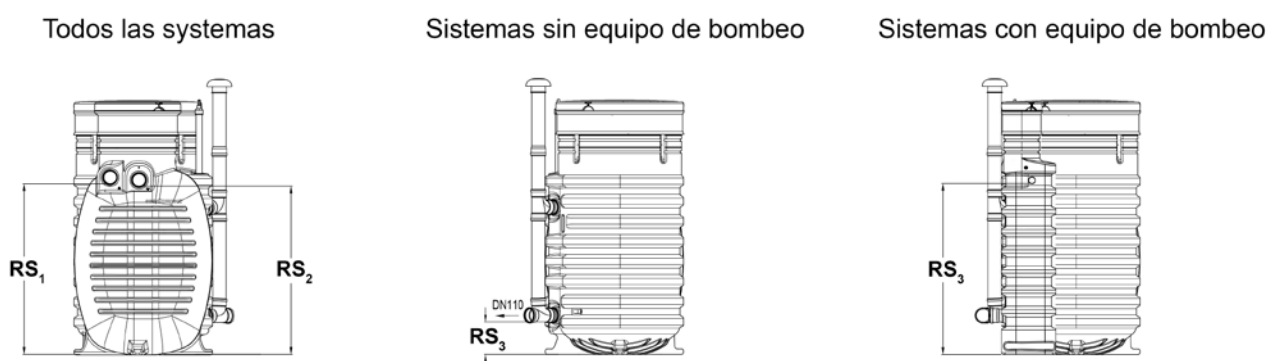
Fig. 8: Dimensiones de conexión de Depuradora compacta easyCompact
