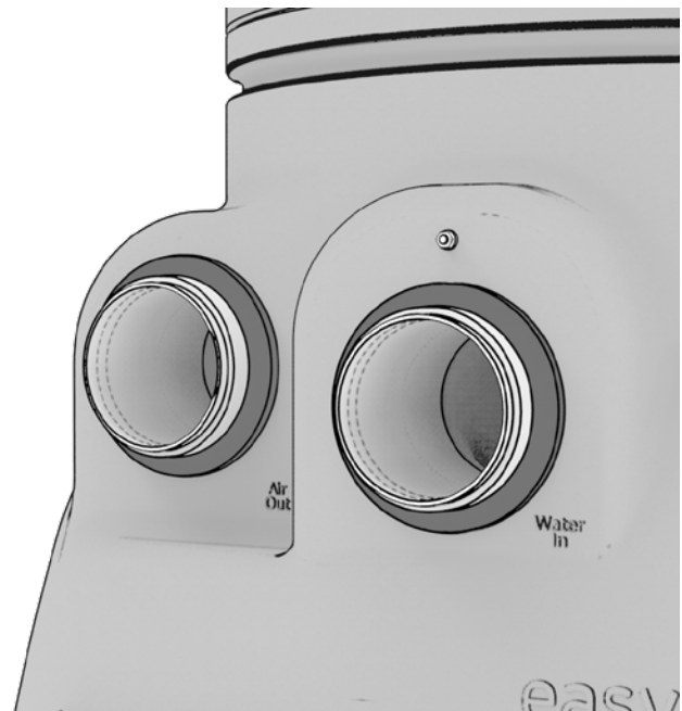
Fig. 16: Conexiones para entrada y desaireación
