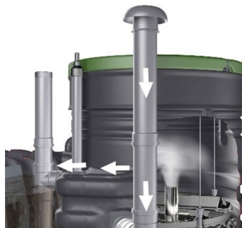
Fig. 12: Test de fumée
