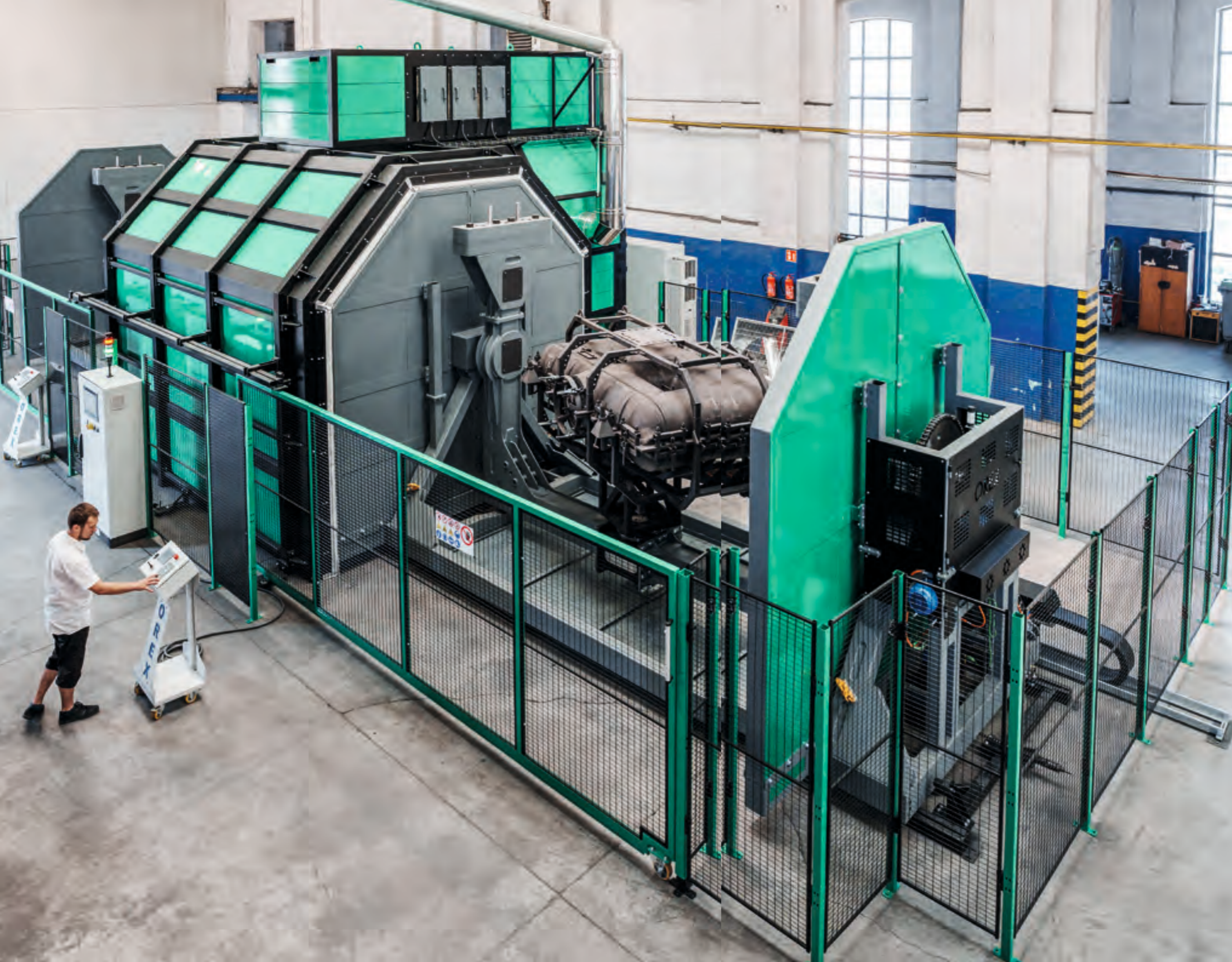
<< Die Jungfernfahrt Projektleiter Christoph Kanafek fährt seine neueste Maschine zum ersten Mal hoch. Die 25 Tonnen schwere Anlage kann vollständig mit Strom von regenerativen Energieträgern oder falls notwendig mit Gas betrieben werden und Formen bis zu 3,5 Metern Größe schlucken
