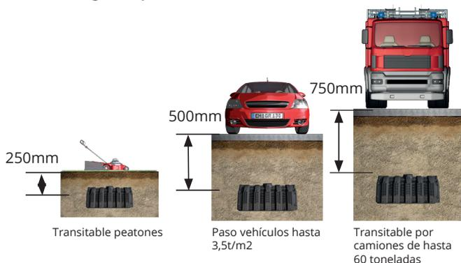
La estructura especial del túnel de infiltración GRAF garantiza un alto rendimiento de infiltración.
