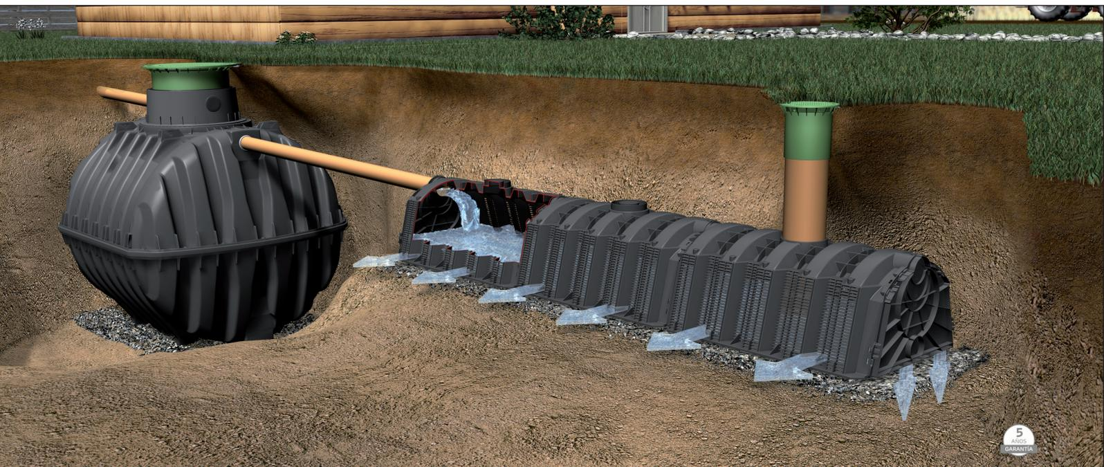
¿No hay ningún río o zona para evacuar el agua tratada cerca de tu casa? Entonces puedes infiltrar el agua tratada en el subsuelo utilizando el túnel de infiltración GRAF. Sólo necesitas un terreno suficientemente permeable a una distancia mínima de 1 m de los niveles freáticos.
