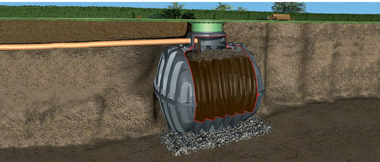
Las fosas sépticas de una cámara permiten almacenar las aguas residuales para su posterior extracción.
