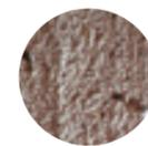
Matériau de remblai en sable stabilisé Sable 0-4 avec ciment, dosé à 200 kg de ciment par m<sup>3</sup> ou gravier 4/6 mm avec drainage périphérique et puits de décompression (cf. Guide de l'utilisateur)
