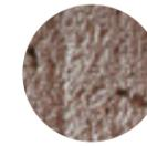
Matériau de remblai en sable stabilisé Sable 0-4 avec ciment, dosé à 200 kg de ciment par m<sup>3</sup>
