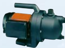
Bomba Garden Jet 700 Bomba autoaspirante Potencia de 0,7 KW, altura máx. 40 m, presión máx. 4,0 bar, caudal máx. 3000 l/h, altura máx. de aspiración 8 m, largada máx. de aspiración 15 m. Código 354012
