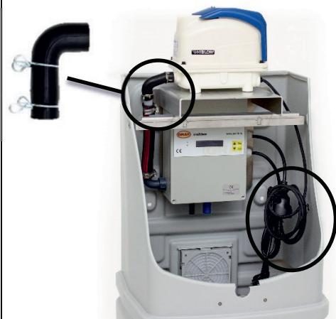
Le compresseur est placé sur la commande. Pour le raccordement de l'air, il faut utiliser le coude en caoutchouc. Pour le raccordement électrique, la fiche du compresseur est insérée dans la prise de la commande.
