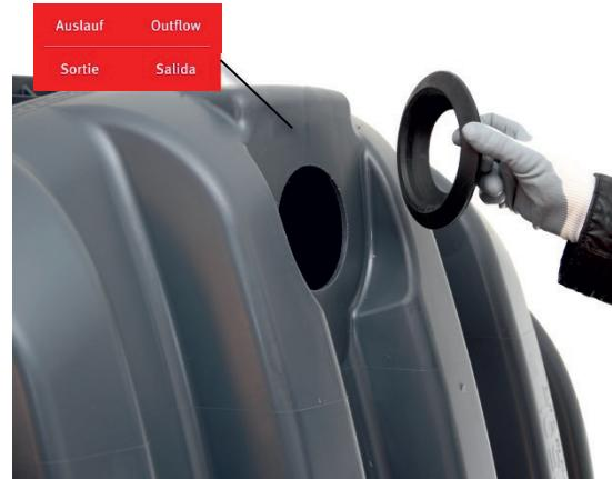
Ebavurer avant de mettre en place le joint à lèvres DN 110. Pour l'écoulement, le sens de passage doit être de l'intérieur vers l'extérieur.
