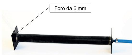
Fissare il laccio all'aeratore tubolare (foro da 6 mm). All'estremità opposta collegare il tubo di aerazione (19 mm). Negli impianti per più di 7 abitanti si utilizzano 2 aeratori tubolari.
