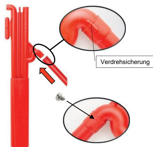
Der Ansaugstutzen auf den Heber stecken. Verdrehssicherung beachten. Den Ansaugstutzen mit Schraube (3,5x6,5) sichern
