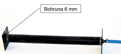
Am Rohrbelüfter muss die Schnur befestigt werden (Bohrung 6mm). An der Gegenseite ist der Luftschlauch (19mm) anzuschließen. Anlagengrößen über 7 EW enthalten zwei Rohrbelüfter.
