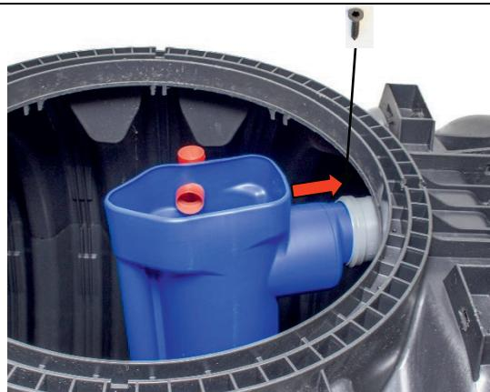
Włożyć złącze odpływowego punktu poboru próbek do rury odpłybowej (użyj smaru!). Połączenie musi być zabezpieczone śrubą Spax.
