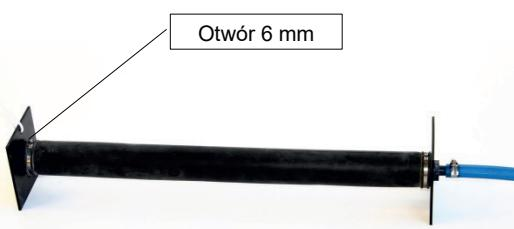
Na dyfuzorze rurowym należy zamocować sznur (otwór 6mm). Po przeciwej stronie podłączyć przewód powietrznego (19mm). Oczyszczalnie ścieków dla ponad 7 osób muszą być wyposażone w dwa dyfuzory rurowe.
