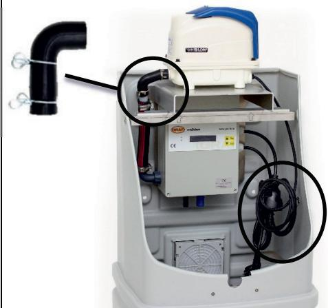
Der Verdichter wird auf die Steuerung gestellt. Zum Luftanschluss ist der Gummi-Winkel zu verwenden. Zum Stromanschluss wird der Stecker des Verdichters in die Buchse der Steuerung gesteckt.
