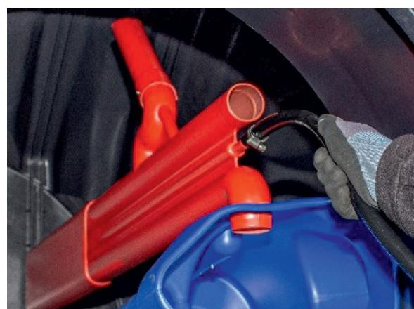
Raccorder le tuyau d'air (13mm) au levier d'évacuation d'eau claire.
