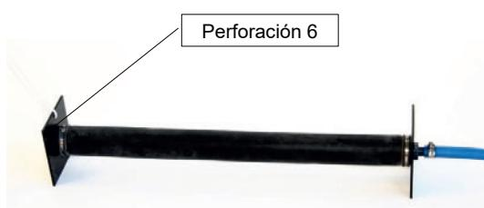
Fijar la cuerda en el difusor tubular (perforación 6 mm). Conectar la manguera de aire (19 mm) en el lado opuesto. Las depuradoras para más de 7 HE incluyen dos difusores tubulares.
