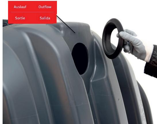
Retirar la perforación. Colocar la junta de goma DN 110. En la salida, se debe colocar desde dentro hacia afuera.
