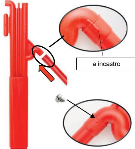
Inserire il manicotto di aspirazione sul sollevatore. Fare attenzione al dispositivo antitorsione. Fissare il manicotto di aspirazione con la vite (3,5x6,5).
