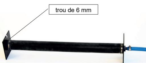
La cordelette doit être fixée à l'aérateur tubulaire (trou de 6mm). Le tuyau d'air (19 mm) doit être raccordé au côté opposé. Les installations de plus de 7 EH contiennent deux aérateurs tubulaires.
