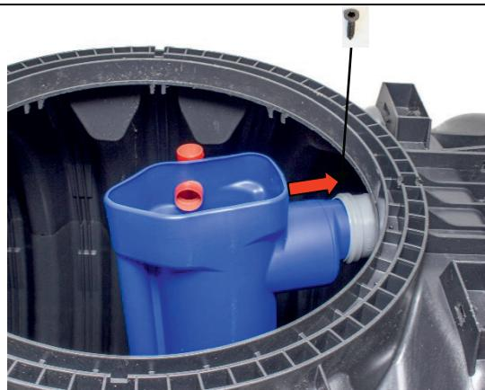
Infilare il bocchettone di uscita dell'unità di campionamento nel manicotto del tubo di uscita (utilizzare un lubrificante!). Il raccordo a manicotto deve essere fissato con viti Spax.
