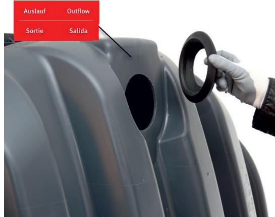
Pulire il foro dalle sbavature. Inserire la guarnizione a labbro DN 110. Per l'uscita la direzione di inserimento deve essere dall'interno verso l'esterno. Applicare l'adesivo "Uscita".
