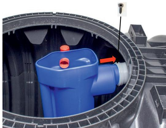
Le tuyau de sortie du prélèvement d'échantillons est inséré dans le manchon du tube de sortie (utiliser un lubrifiant!). Le raccord du manchon doit être sécurisé à l'aide d'une vis courte.
