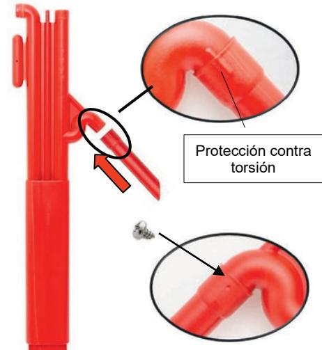
Coloque el tubo de aspiración en el sifón elevador. Tenga en cuenta el seguro anti torsión. Asegure el tubo de aspiración con el tornillo (3,5x6,5).
