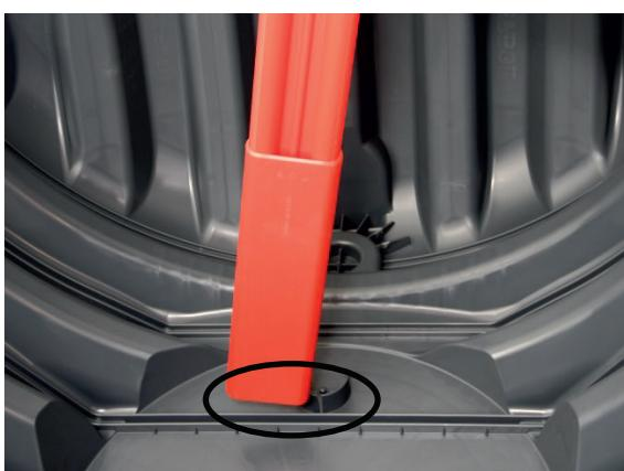
Le levier s'insère par le haut dans la rainure du réservoir Carat.
